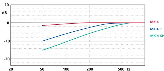
Frequenzgänge der 2 Stufen P und XP im Vergleich zur Standardkapsel MK 4 (bei einem gleichbleibenden Abstand von 60 cm gemessen).
