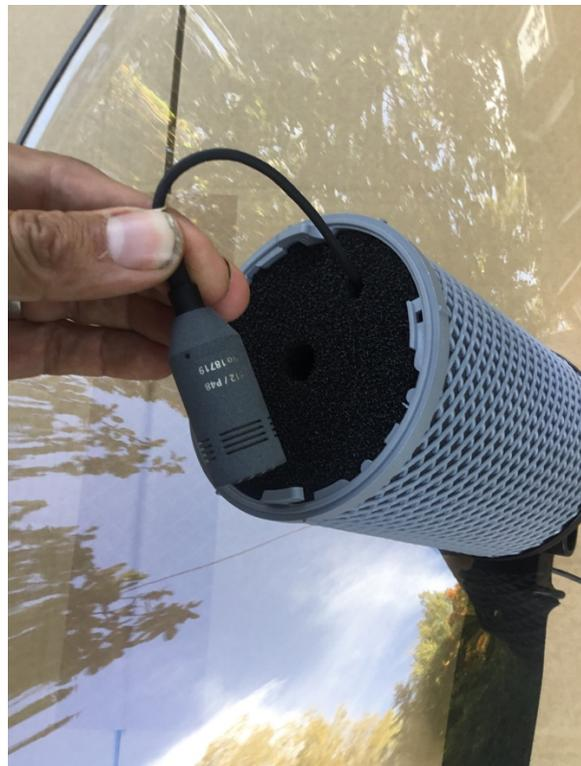
**STEP 8. PLACE AND SECURE THE SCHOEPS MICROPHONE INSIDE THE RYCOTE MICROPHONE HOLDER FOAM.**
