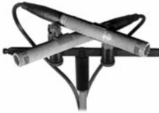
Abb. 2 ORTF, Kapselabstand: 17cm, Winkel: 110°; (grüne Markierungen)
