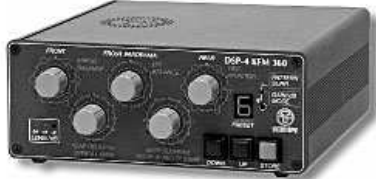
DSP-4 KFM 360 Steuereinheit mit integrierten A/D- und D/A-Wandlern
